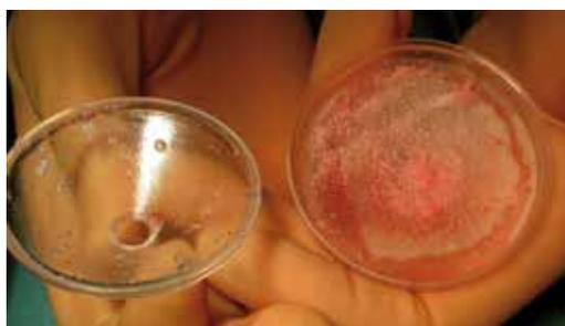
Filtro de 48 mm de diámetro, apertura de malla de 300 µm
