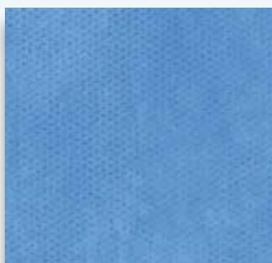
La estructura de la fibra en panal de esta tela no tejida (NWF) garantiza una barrera efectiva al paso de fluidos y patógenos, proporcionando una comodidad excelente de uso al operario. La fibrillas están orientadas de un modo concreto que proporciona un tejido muy resistente y suave al tacto.
